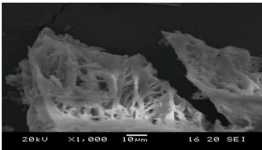
**FIG 2.1: SEM IMAGE SHOWS SILICA PARTICLES OBTAINED BY USING HNO3 IN ACID WASHING**
