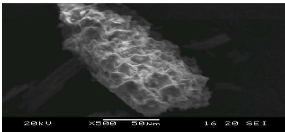
**FIG 3 SEM IMAGE SHOWS SILICA PARTICLES OBTAINED BY USING H2SO4 IN ACID WASHING**
