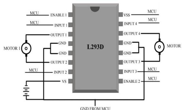
Fig: L293D Pin diagram
