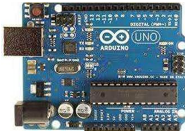
Fig.6. Arduino UNO R3
